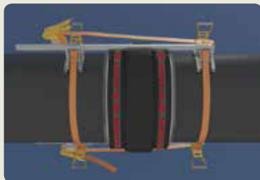
A csövek rögzítése a hegesztés alatt
